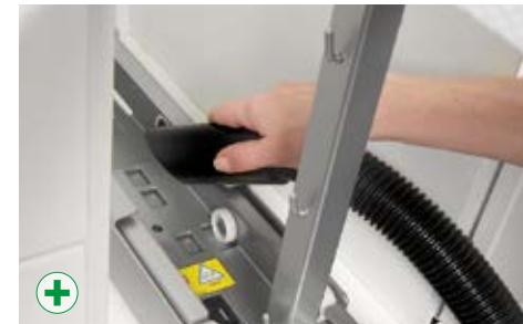
Pour éviter des anomalies de fonction de la ferrure du coulissant il est nécessaire de toujours protéger celle-ci contre des salissures (par ex. farine, riz, panelure, etc.) ou s'il est nécessaire de les éliminer.
